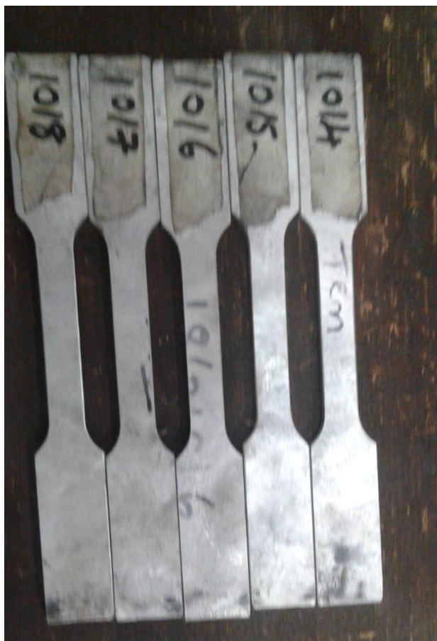
Fig. 4. Tensile Test Specimen.
